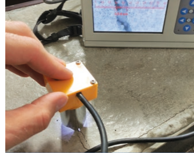
Boven: Plastische krimpscheuren gemeten d.m.v. een digitale microscoop Onder: Uitvoering van een druklaag met Durus EasyFinish wapening
