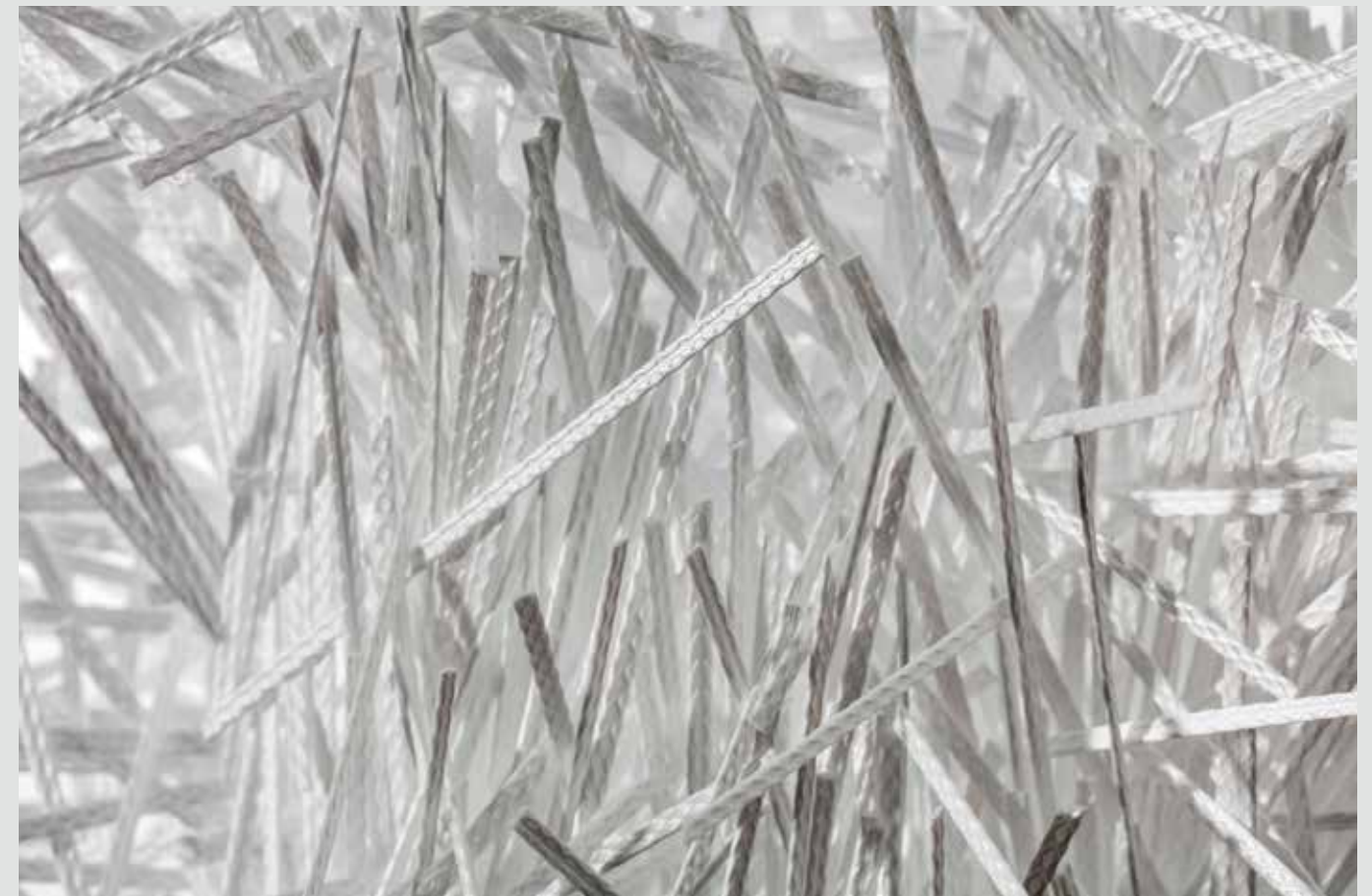
Durus S500 heeft een langgerokken ontwerp. Dit maakt dat het specifieke reliëfoppervlak van de vezel gemaximaliseerd wordt en dat hij zijn mechanische eigenschappen makkelijker behoudt bij verwerking.
